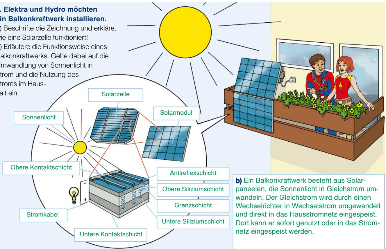
**b)** Ein Balkonkraftwerk besteht aus Solarpaneelen, die Sonnenlicht in Gleichstrom umwandeln. Der Gleichstrom wird durch einen Wechselrichter in Wechselstrom umgewandelt und direkt in das Hausstromnetz eingespeist. Dort kann er sofort genutzt oder in das Stromnetz eingespeist werden.
